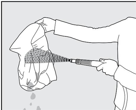
Nettoyez le sac de filtrage à l'aide d'un tuyau d'eau. Nous recommandons de laver de temps en temps le sac de filtrage en machine à laver en utilisant le programme pour tissus délicats. De temps en temps, rincez les brosses à l'aide d'un tuyau d'eau.
